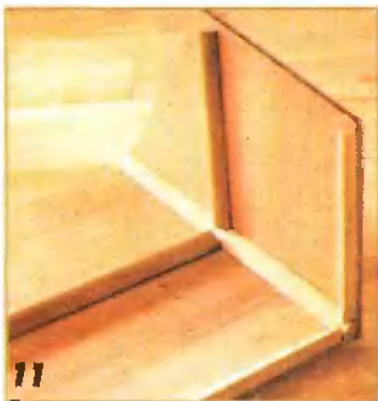
11 Приклеивают и крепят шурупами бруски длиной 265 мм к коротким прямым ребрам боковых стенок, а брусок длиной 300 мм — поперек середины.
