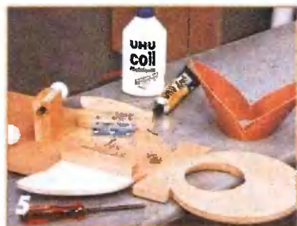
Крылья «цыпленка» крепят к туловищу на обычных картонных петлях. Бруски, к которым привинчивают петли шурупами, одновременно служат ребрами жесткости.
