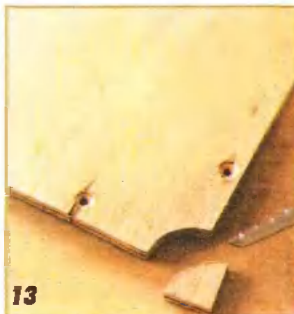
13 На одной длинной и двух коротких сторонах сиденья 582x330 мм сверлят и зенкуют вспомогательные отверстия Ø4,5 мм. На длинной стороне располагают отверстия в 8 мм от краев листа, крайние из них — на расстоянии 60 мм от углов, а два — равномерно между ними. На коротких сторонах отверстия располагают также, но между ними сверлят по одному отверстию. Ставят обрезок бруска в задние углы сиденья, очерчивают вокруг них дуги и выпиливают полученные секторы.
