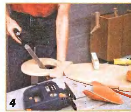
Сложив вместе половинки клюва, размечают контуры отверстия в заготовке головы «цыпленка», а затем вырезают его с помощью электролобзика. Сколы внутренних кромок отверстия подгоняют по месту напильником с крупной насечкой.
