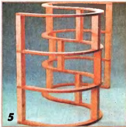
5 Бруски на торцах каркаса необходимо совместить один с другим строго заподлицо, то есть расположить их на одной вертикальной линии.
