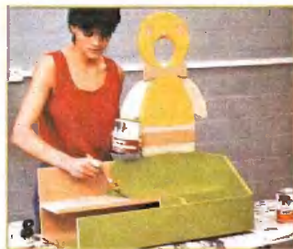
Окрашку фигурок-мишеней и ящика-подставки выполняют по отдельности и до окончательной сборки игрушки.
