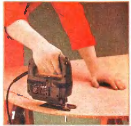
S-образные элементы выпиливают электролобзиком из ДСП толщиной 19 мм.
