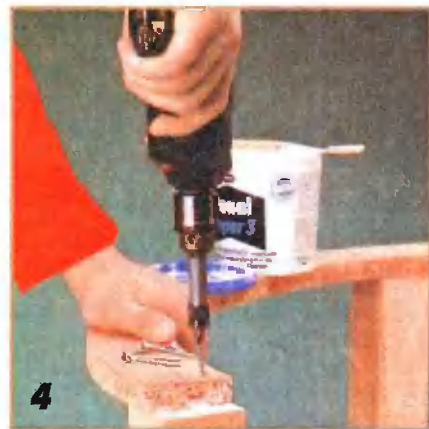
4 Все соединения выполняют на клее и шурупах и прежде всего на стыках между деталями S-образного элемента.
