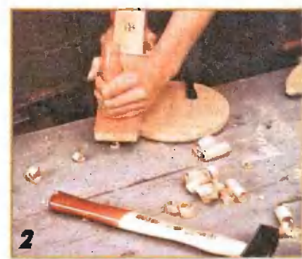
Чтобы голова «мыши» была чуть-чуть наклонена вперед, и уши после попадания в цель сами возвращались в исходное положение, нижнюю часть заготовки с тыльной стороны нужно сострогать на скос.
