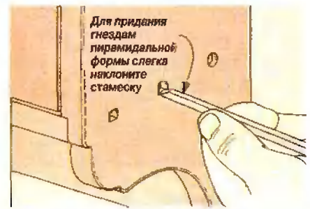
Рис. 16. Затем стамеской придайте отверстиям квадратную форму. Чтобы пробки зашли легко, скруглите их ребра шкуркой, затем смажьте клеем и забейте пробки на место.
